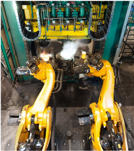
轻型活动： 两台库卡机器人的同步运动，能够轻松协同完成，即使锻造件温度高达 1200 °C。
