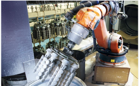
完善的浸渍工艺： 运动的精确度和自由度是模组的沾浆和砂型涂料中获得最佳层排列的前提条件。
