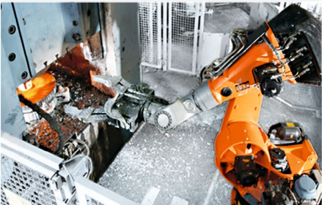
链式落锤锻造过程： 在全自动冲压生产线上以 1250°C 的温度锻造卡车轮毂。库卡机器人能够使零件的产量和产能增大一倍，这是依靠人力生产无法做到的。
