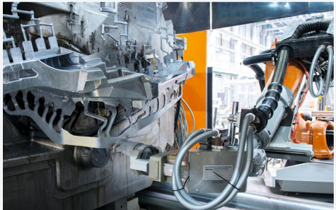
搬运压铸件： KR QUANTEC 能够毫不费力地从压模机上卸下复杂构件。
