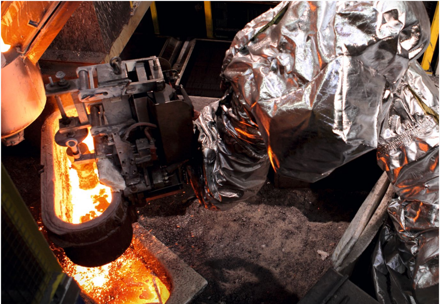
挠性接触铸造： KR 1000 titan 能够以最大的灵活性将装有 1400°C 高温铁水的注包导入砂箱。浇同时浇色可随浇铸机一起运动。
