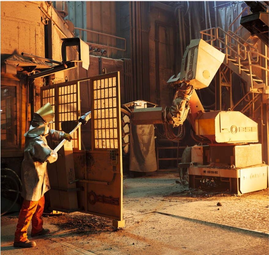
极端操作中的机器人： 一台特别防护的 KR 500 F 帮助炼钢工人采样和执行温度测量任务。自由可编程、客户特定的杆运动，快速连续地进行测量，可提高安全性。
